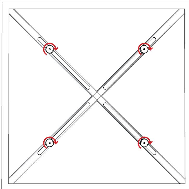
**2-** Glisser les écrous dans le rail et les positionner sous les trous de la croix.
