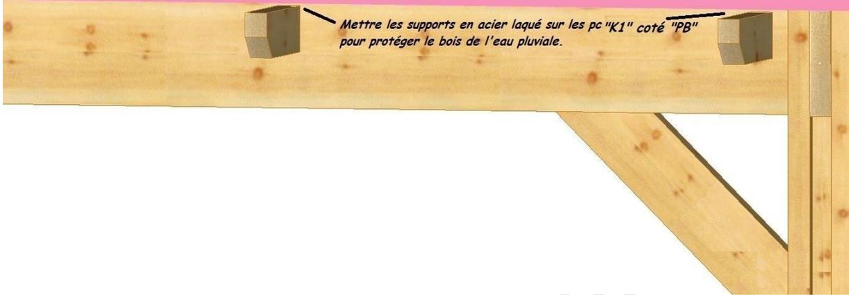
*Mettre les supports en acier laqué sur les pc "K1" coté "PB" pour protéger le bois de l'eau pluviale.*
